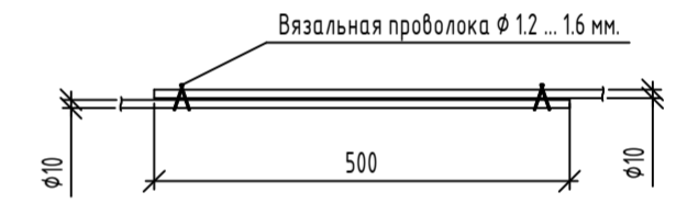
Деталь соединения арматурных стержней
